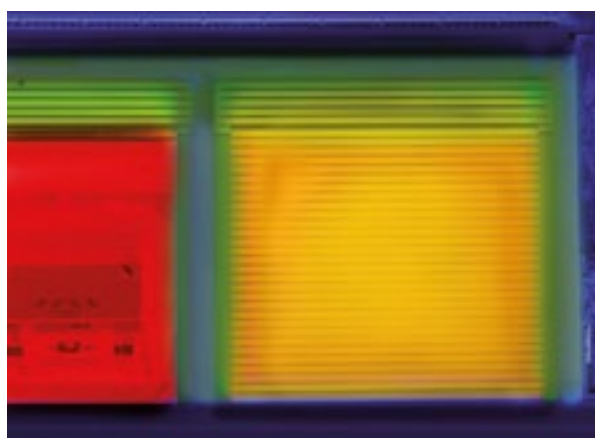
Cette image thermique d'une porte roulante ordinaire montre clairement la grande perte de chaleur vers l'extérieur.
